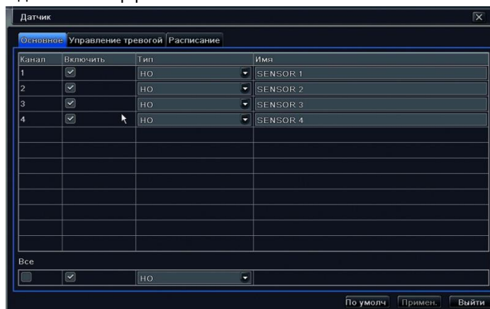
Рис. 4.20. Настройка основных параметров тревожных входов.
